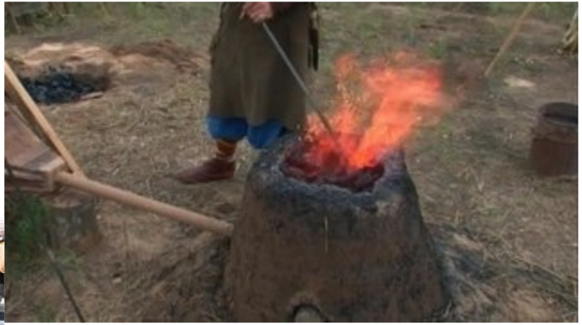
Реконструкция древнего способа получения железа (крицы) про помощи сыродутного горна.
